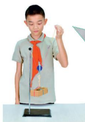
② 测量用动滑轮提升重物时橡皮筋的长度。
