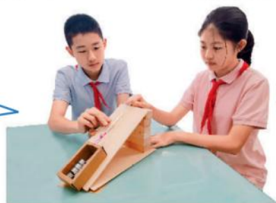
沿坡度较陡斜面提升重物
